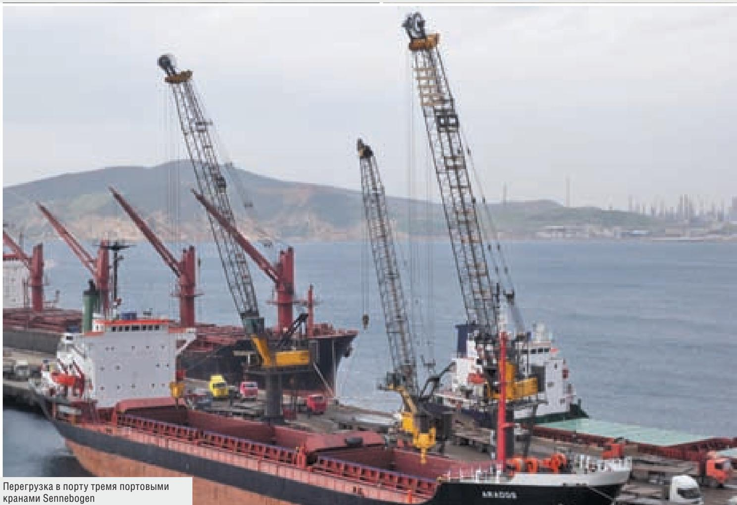
Перегрузка в порту тремя портовыми кранами Sennebogen
