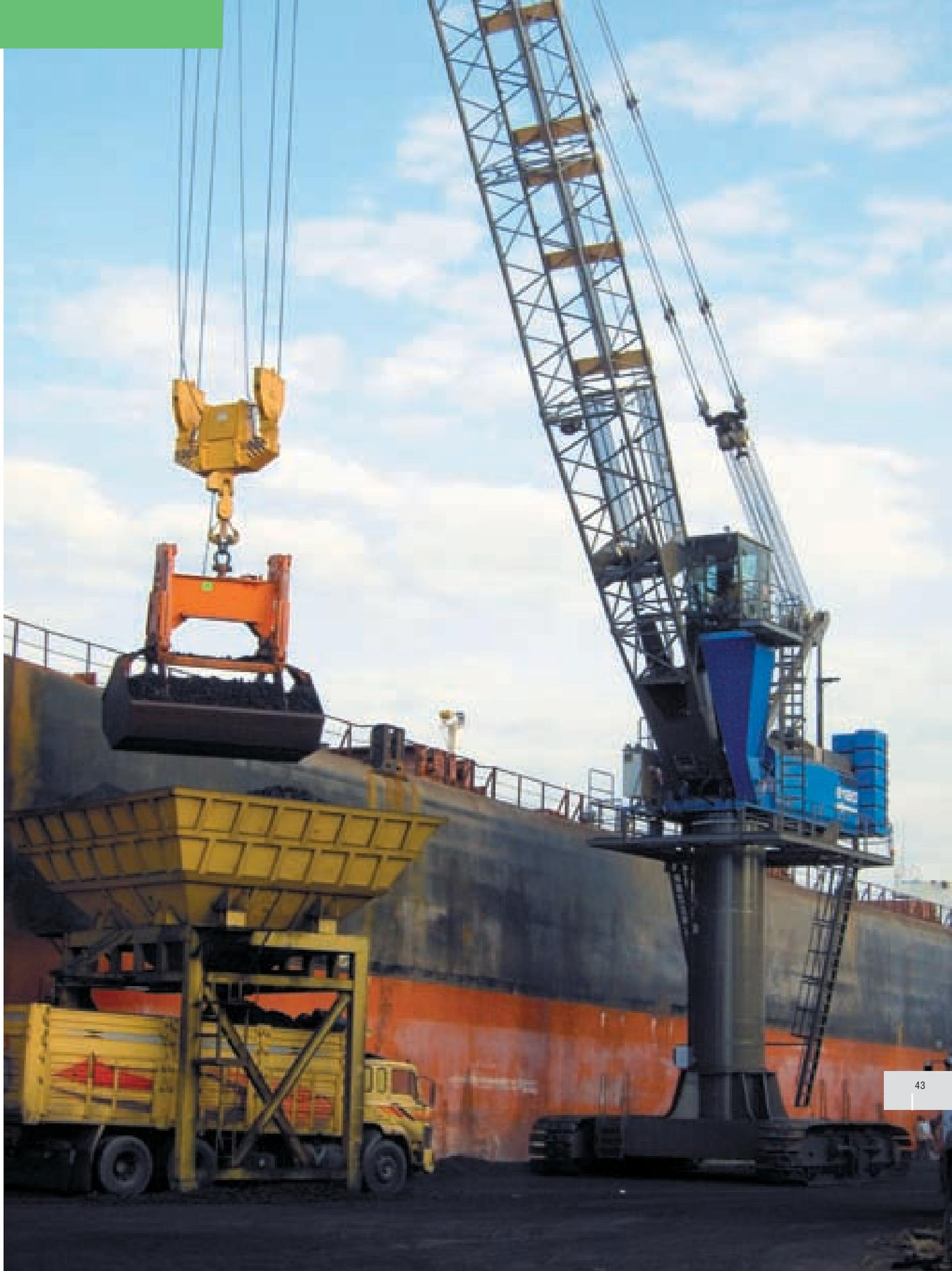
6180 HCC – пилон 8 м – стрела 33 м – выгрузка угля электро-гидравлическим грейфером 25 м<sup>3</sup> на поворотном кране – Турция
