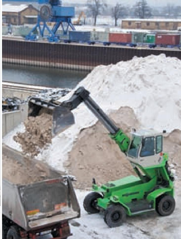
88305 Multihandler – погрузка плавикового шпата на грузовики с помощью ковша объемом 3 м<sup>3</sup>
