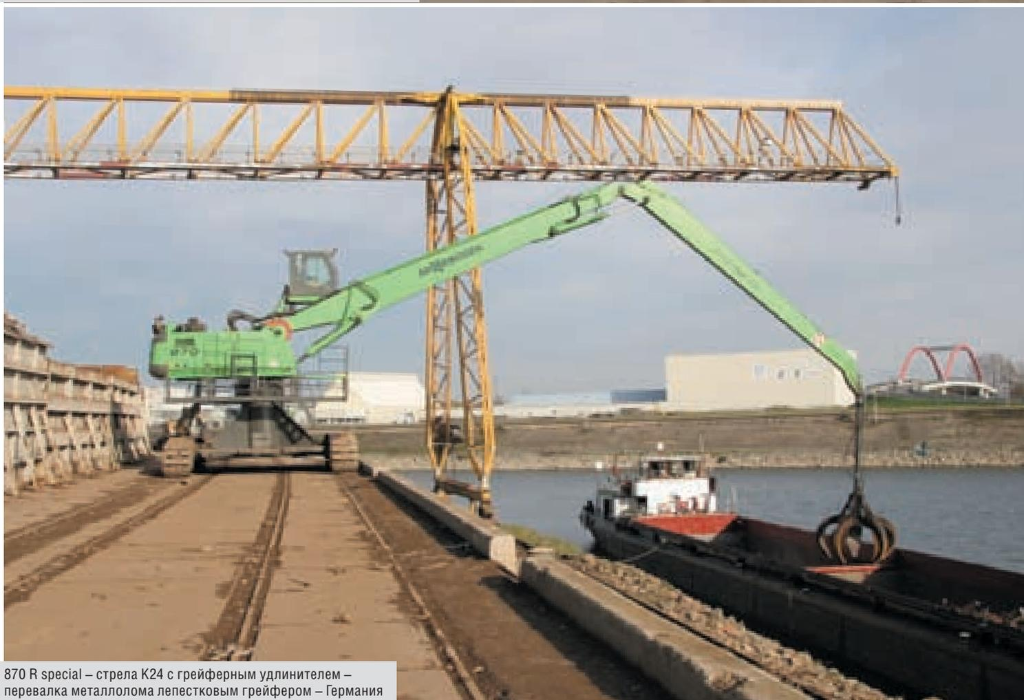
870 R special – стрела K24 с грейферным удлинителем – перевалка металлолома лепестковым грейфером – Германия
