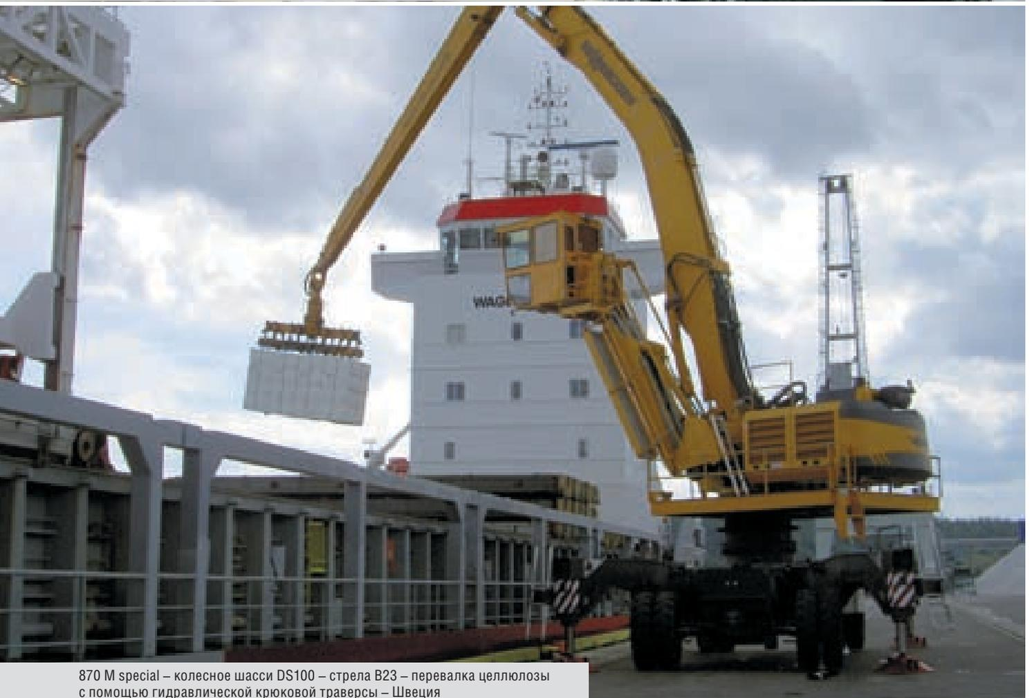
870 M special – колесное шасси DS100 – стрела B23 – перевалка целлюлозы с помощью гидравлической крюковой траверсы – Швеция
