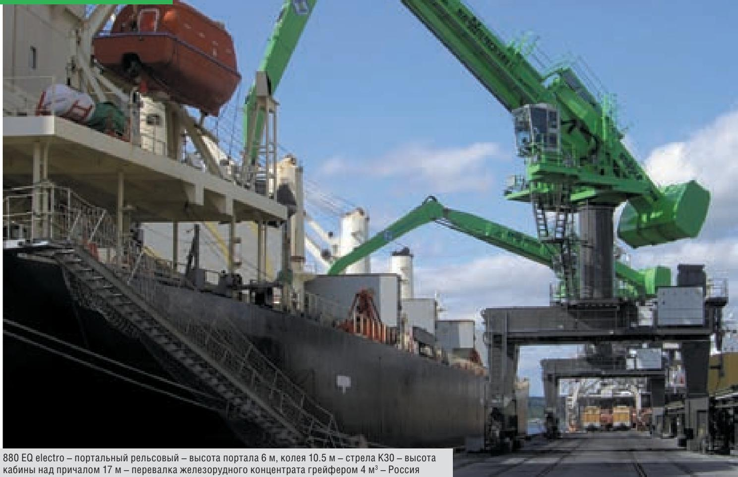
880 EQ electro – портальный рельсовый – высота портала 6 м, колея 10.5 м – стрела K30 – высота кабины над причалом 17 м – перевалка железорудного концентрата грейфером 4 м<sup>3</sup> – Россия
