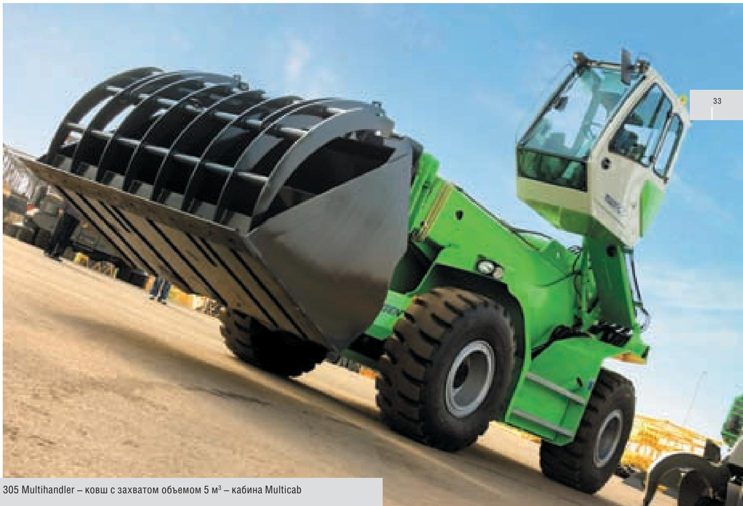
305 Multihandler – ковш с захватом объемом 5 м<sup>3</sup> – кабина Multicab
