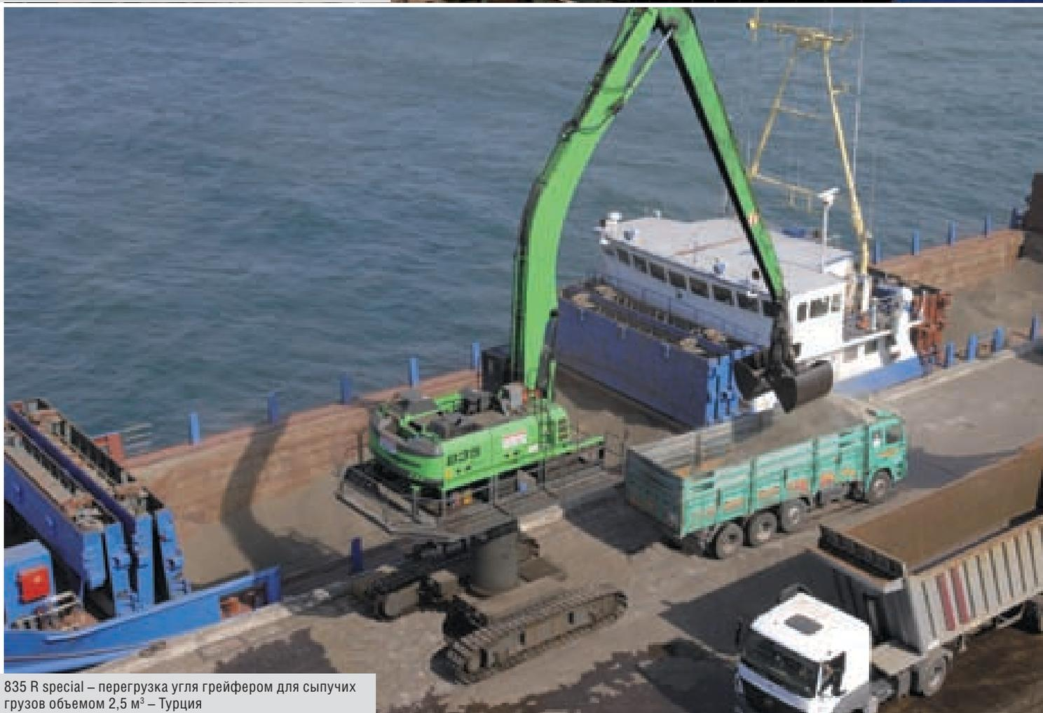
835 R special – перегрузка угля грейфером для сыпучих грузов объемом 2,5 м³ – Турция
