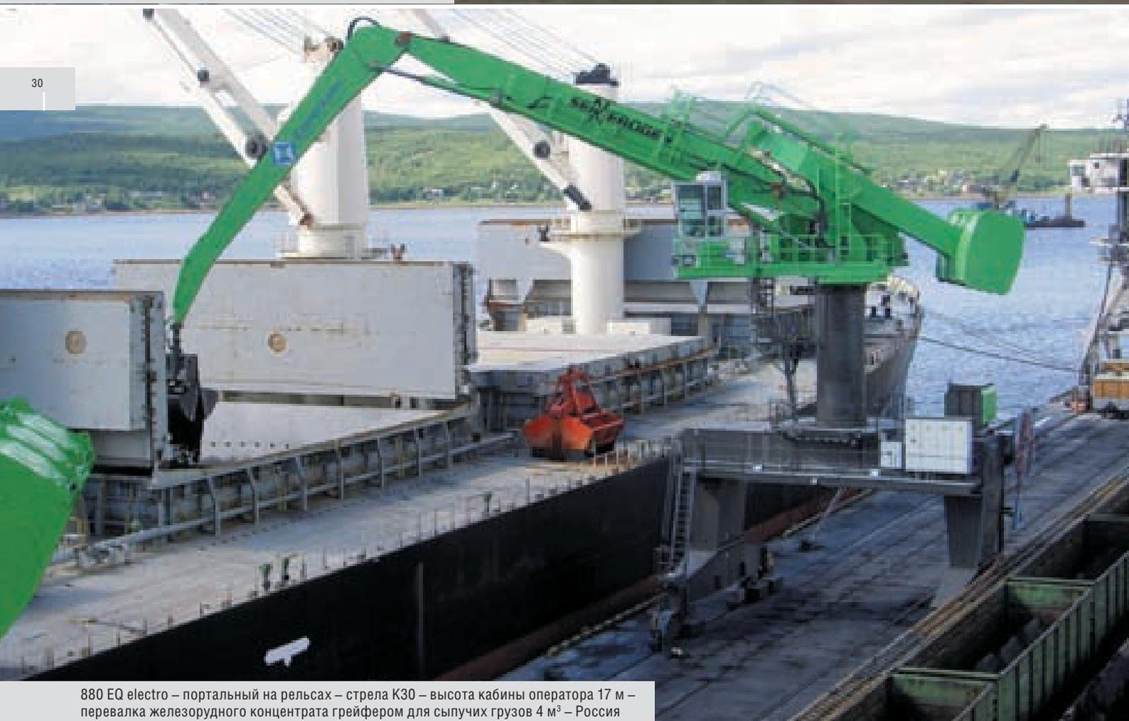
880 EQ electro – порталный на рельсах – стрела К30 – высота кабины оператора 17 м –
