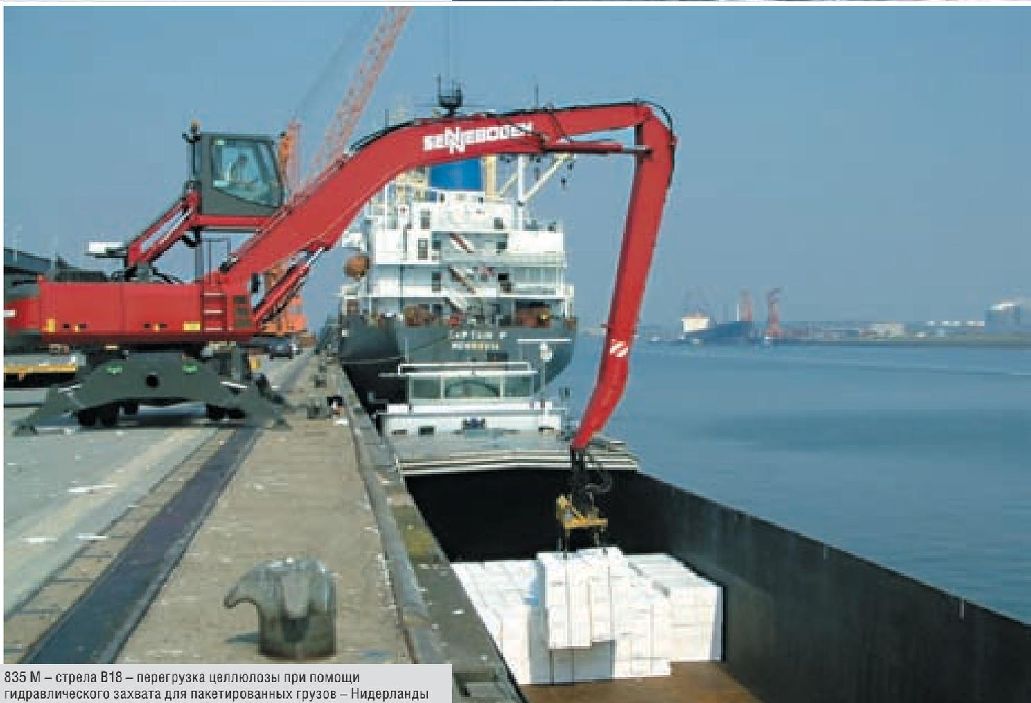
835 M – стрела V18 – перегрузка целлюлозы при помощи гидравлического захвата для пакетированных грузов – Нидерланды
