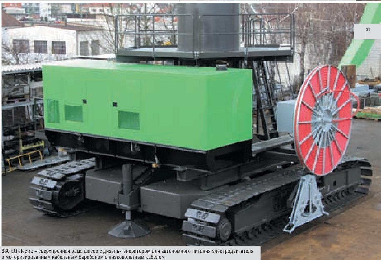
880 EQ electro – сверхпрочная рама шасси с дизель-генератором для автономного питания электродвигателя и моторизованным кабельным барабаном с низковольтным кабелем
