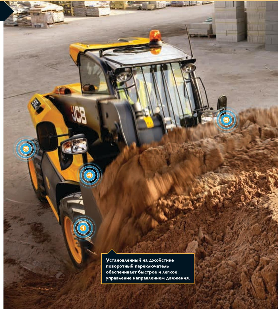
Установленный на джойстике поворотный переключатель обеспечивает быстрое и легкое управление направлением движения.
