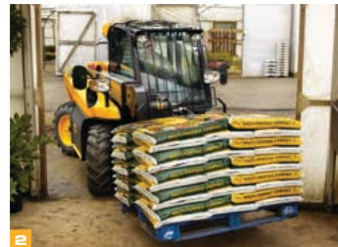
5 Впечатляющая грузоподъемность для такой небольшой машины. Можно поднимать до 1600 кг по подъемной дуге стрелы до полной высоты 4 м. Кроме того, грузоподъемность 1000 кг с вылетом вперед 2 м позволяет легко и безопасно загружать тюки в прицеп и выгружать их из него.
