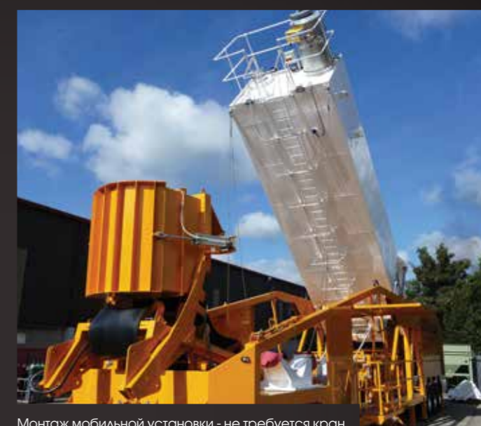
Монтаж мобильной установки - не требуется кран
