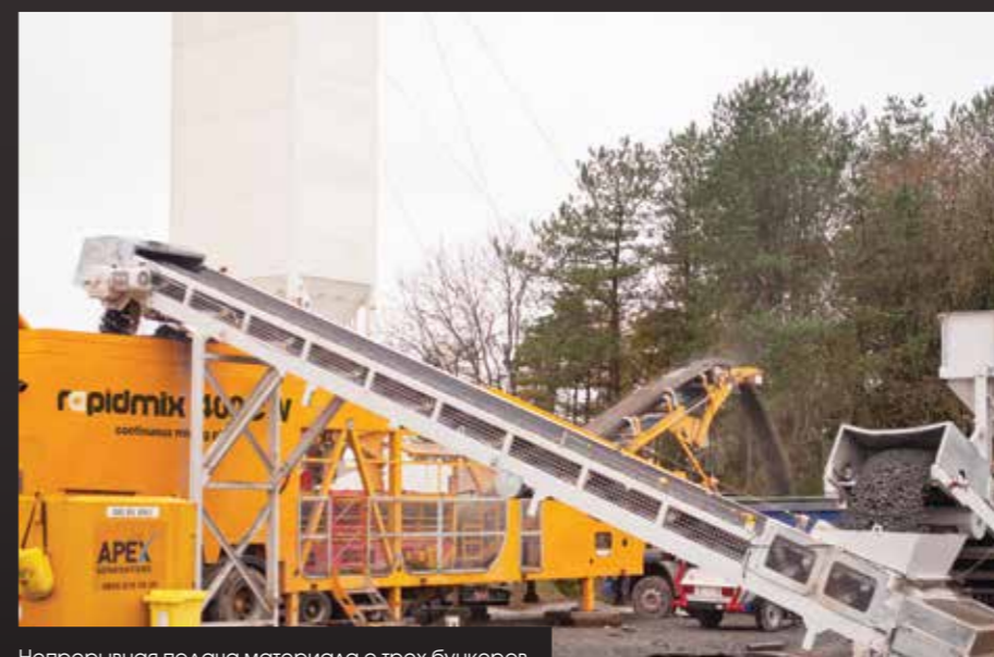
Непрерывная подача материала с трех бункеров
