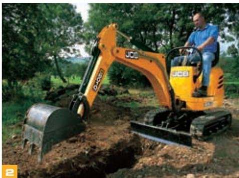
Самая высокая в классе мощность сокращает временные и трудовые затраты при выполнении тяжелых экскаваторных работ, а стрела трубчатой конструкции модели 8008 отличается уменьшенной массой и обеспечивает защиту шлангов.
