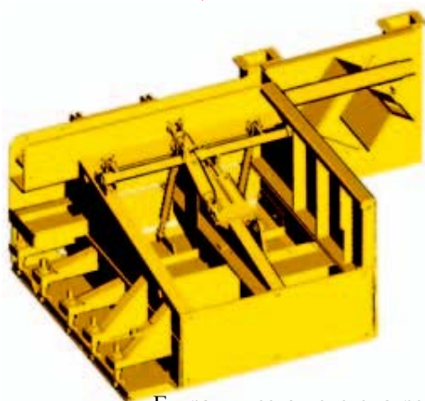
Гидравлическая система регулирования оборудования для формирования кромки.
