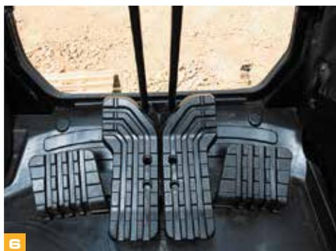
**6** Большая площадь пола и крупные педали с хорошим сцеплением с обувью обеспечивают удобство и точность управления движением.
