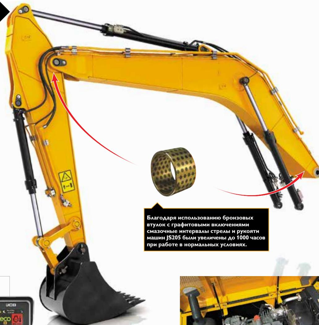
Благодаря использованию бронзовых втулок с графитовыми включениями смазочные интервалы стрелы и рукояти машин JS205 были увеличены до 1000 часов при работе в нормальных условиях.
