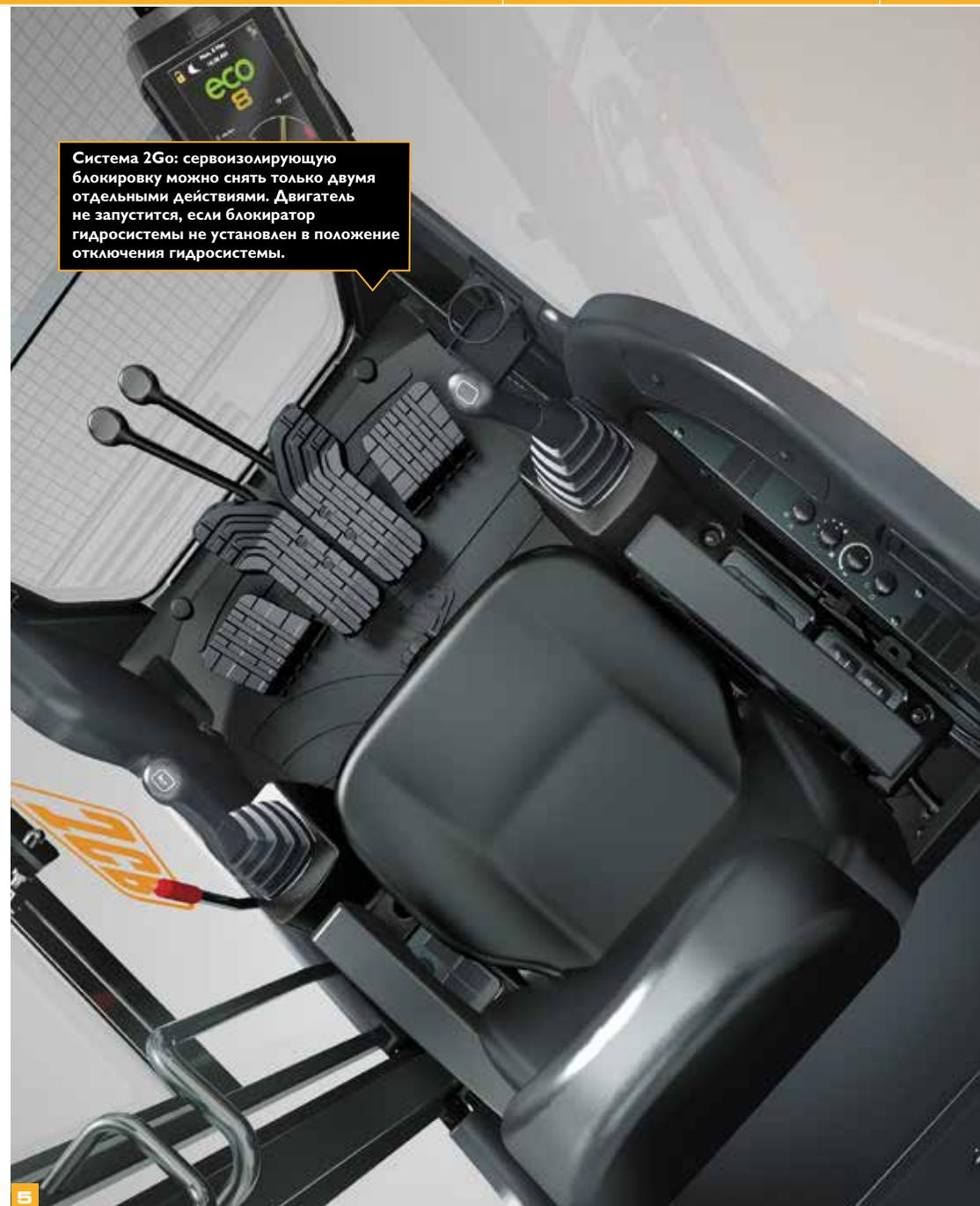
**Система 2Go: сервоизолирующую блокировку можно снять только двумя отдельными действиями. Двигатель не запустится, если блокиратор гидросистемы не установлен в положение отключения гидросистемы.**
