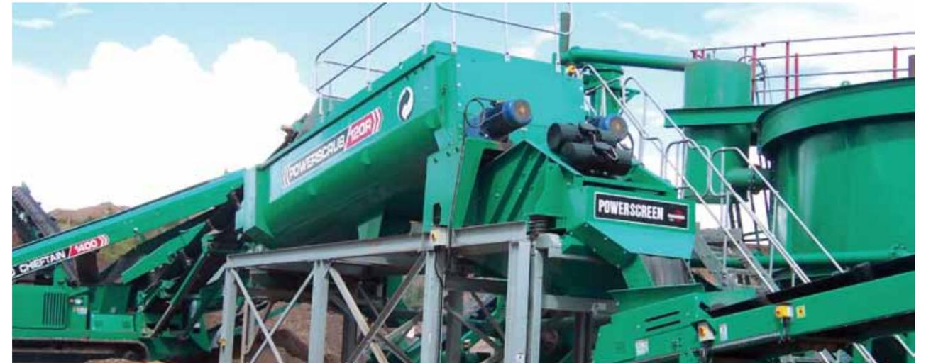
Серия Powerscrub R 120R 200R Масса (расчетная) 17,000кг 26,500кг Рабочая ширина 3.5м 3.35м Рабочая длина 12.13м 13.11м Рабочая высота 5.39м 5.39м.
