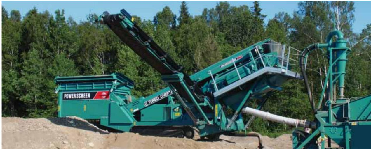
Powerscreen® Chieftain 1400 Rinser – это полностью мобильная установка для промывки и сортировки с трехсторонним разделением материала, предназначенная для операторов и подрядчиков малого и среднего масштаба. Она идеально подходит для таких материалов, как уголь, щебень, переработанные материалы, железная руда, песок и гравий, и может работать самостоятельно или в рамках комплексной установки для промывки, что делает ее одной из самых гибких машин в отрасли.
