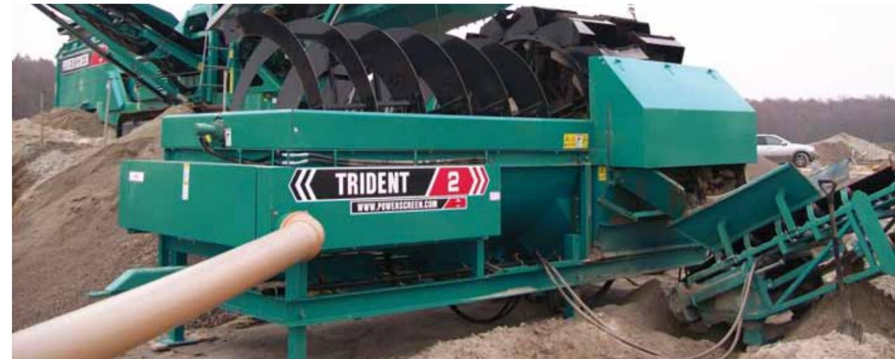
Обезвоживающая установка Powerscreen® Trident – это мобильная шнековая восстанавливающая установка с двойным черпальным колесом, удаляющая глину, ил и шлам и позволяющая производить до 2 фракций песка. Серия изделий Trident максимально универсальна и может удовлетворять самым разным требованиям, таким как максимальное удержание мелких фракций или максимальное удаление мелких фракций.
