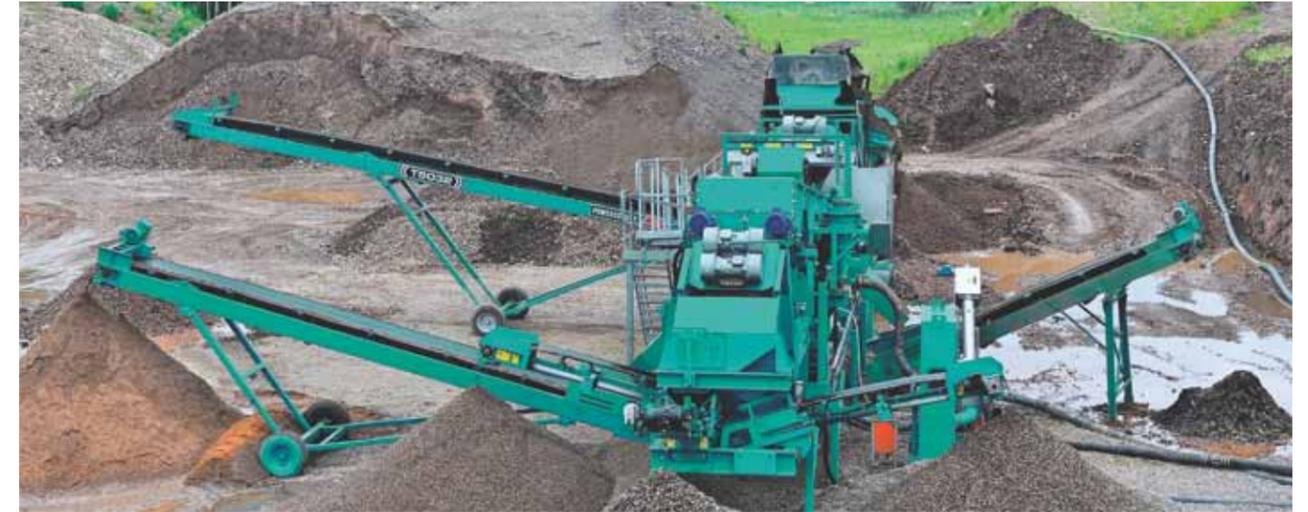
Аggwash Масса (расчетная) 28,600кг Транспортная ширина 2.70м Транспортная длина 16.20м Транспортная высота 3.63м
