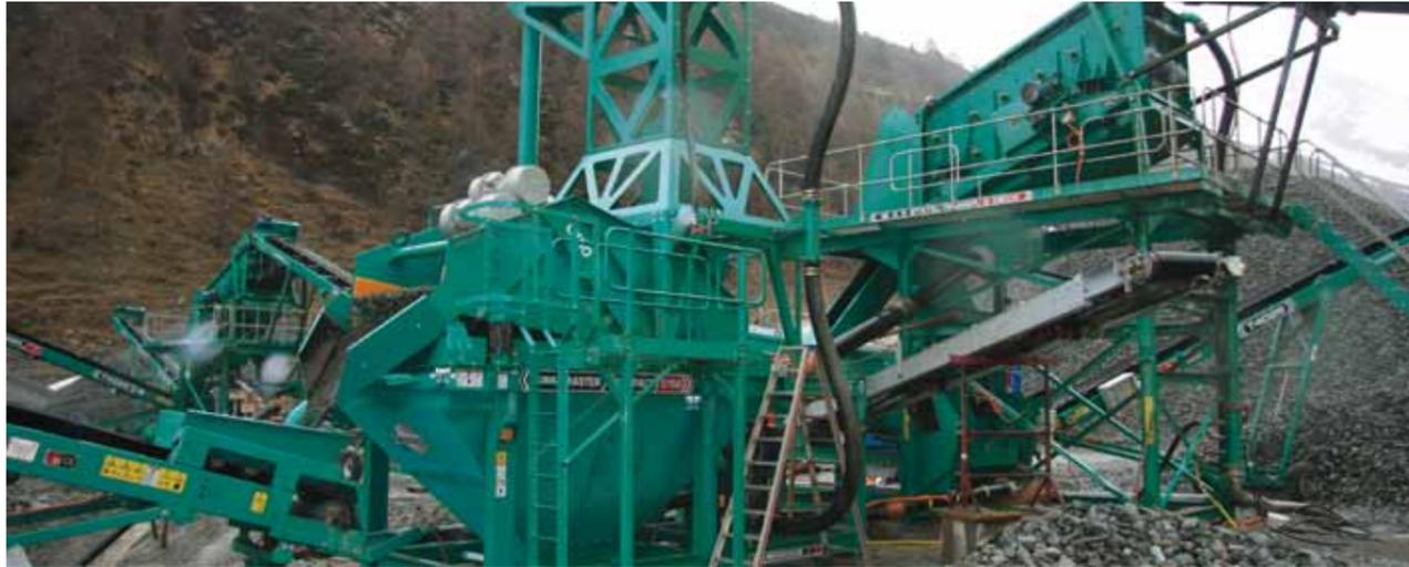
Серия Powerscreen® Finesmaster Compact – это стационарные установки для восстановления песка, которые одновременно и экономичны, и энергоэффективны. В этой серии используется центробежная сила в циклоне(ах) для удаления глины, ила и шлама из песка, чтобы он соответствовал техническим требованиям.
