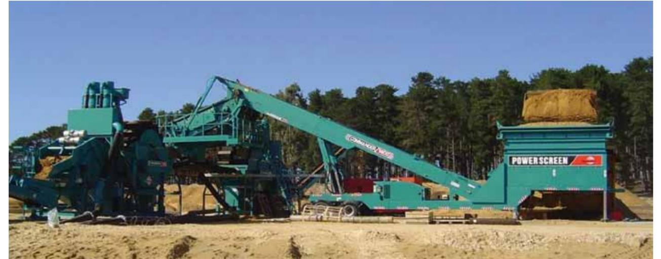
Powerscreen® Commander 1400 Rinser – это высокопроизводительная мобильная мощная установка, которая разработана для быстрой установки и легкого перемещения, что делает ее идеально подходящей для таких материалов, как песок, гравий, уголь и щебень. Commander 1400 Rinser включает загрузочный бункер в комплекте с отклоняющей сеткой, подающий конвейер, Мощный грохот и полностью герметичный силовой агрегат.
