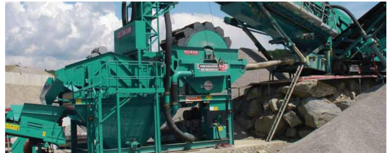
Серия Powerscreen® Finesmaster Bucket Wheel систем сортировки песка – это высокоэффективные обезвоживающие установки. Установки этой серии удаляют ил, шлам и глину из песка для производства до 2 пригодных для продажи продуктов, таких как песок для бетона, строительного раствора и асфальта, каменная пыль / мелкодробленый гравий, озерный и пляжный песок, кварцевый песок, песок для полей для игры в гольф, песок для песчаных фильтров, переработанные материалы и железная руда.
