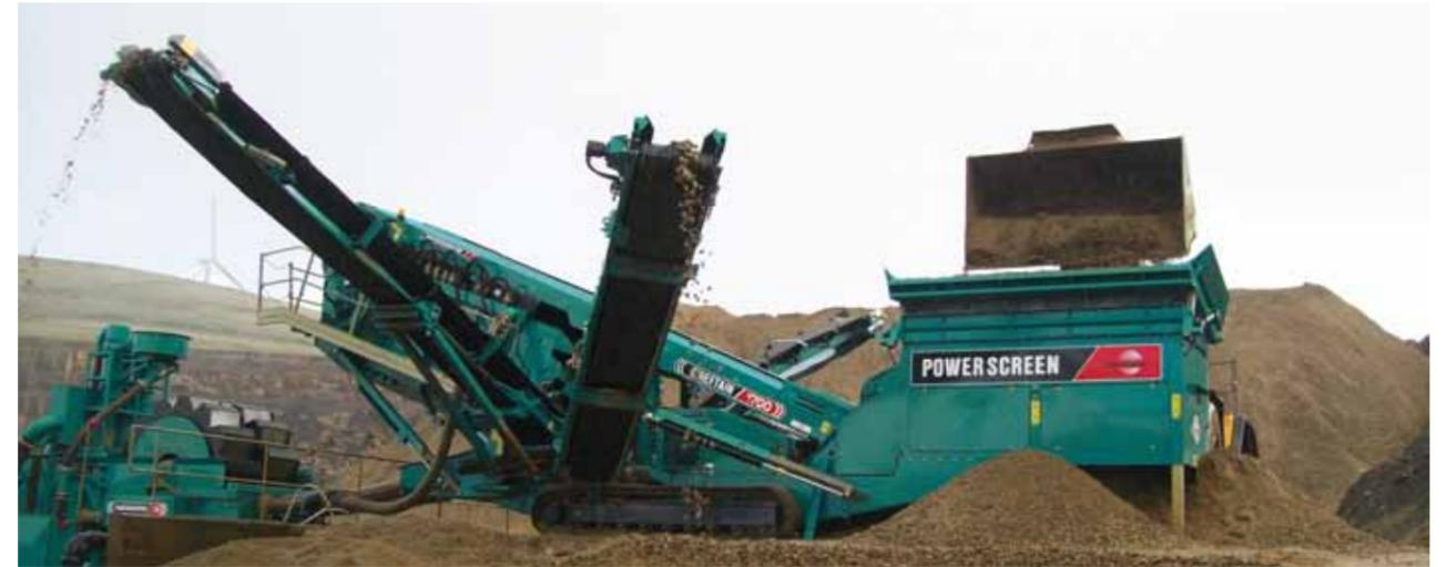
Powerscreen® Chieftain 1700 Rinser – это гусеничная мобильная установка для промывки и сортировки среднего размера, укомплектованная встроенными боковыми конвейерами для трех- или четырехстороннего разделения таких материалов, как уголь, щебень, переработанные материалы, железная руда, песок и гравий. Chieftain 1700 Rinser может работать самостоятельно или в рамках комплексной установки для промывки, что делает ее одной из самых гибких машин в отрасли.
