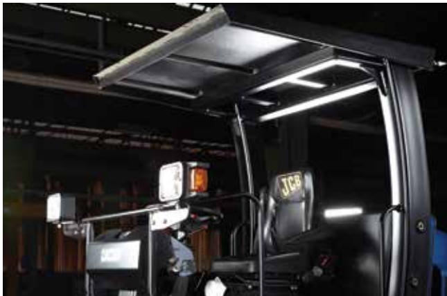
Защита кабины от опрокидывания ROPS и крыши от падающих предметов FOPS.
