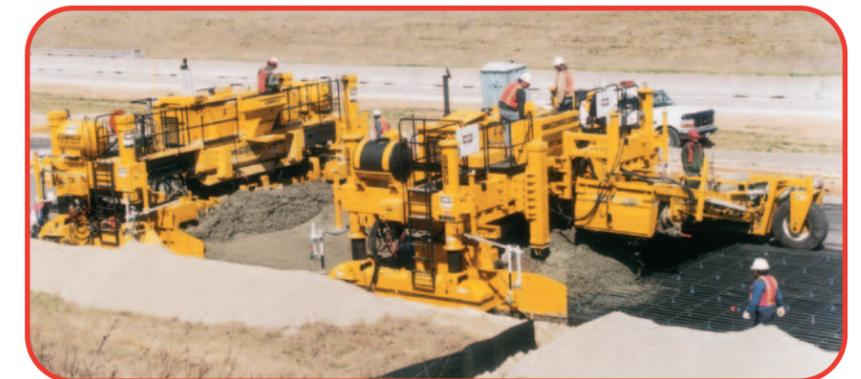
Низкопрофильный капот двигателя бетонораспределителя PS-2600 обеспечивает прекрасную обзорность зоны сзади машины, что позволяет машинисту полностью сохранять контроль за процессом распределения бетонной смеси.
