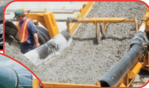
Колесо, установленное на конвейере, сохраняет положение ленты при подъеме и опускании секции рамы для пропуска автосамосвалов.
