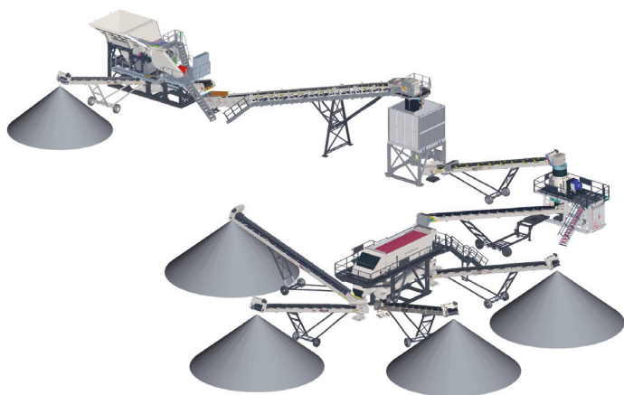
Модульный комплекс 2-этапной обработки с разомкнутым контуром System 200 (щековая дробилка – конусная дробилка – грохот)
