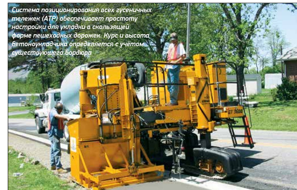
GT-3600 укладывает бордюры и водоотводный лоток под наклоном на проекте по реконструкции дорожного покрытия. Использование функций телескопирования и прижатия формы позволяет бетоноукладчику обходить телефонные столбы с минимальным зазором укладываемого покрытия
