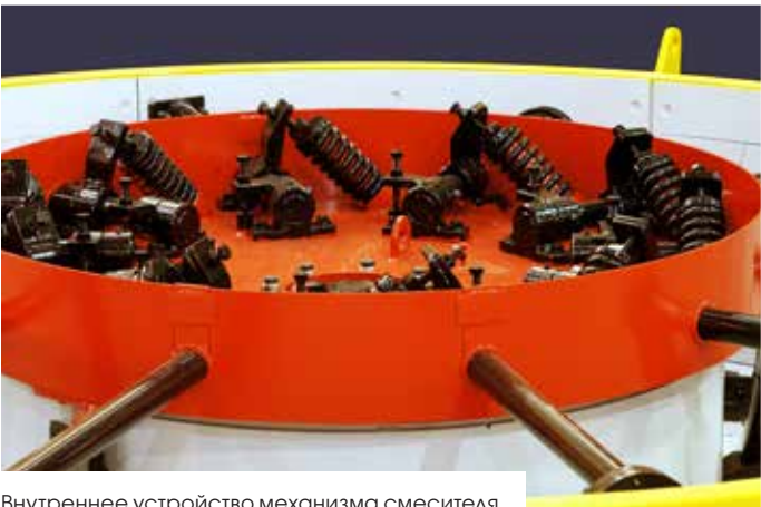
Внутреннее устройство механизма смесителя
