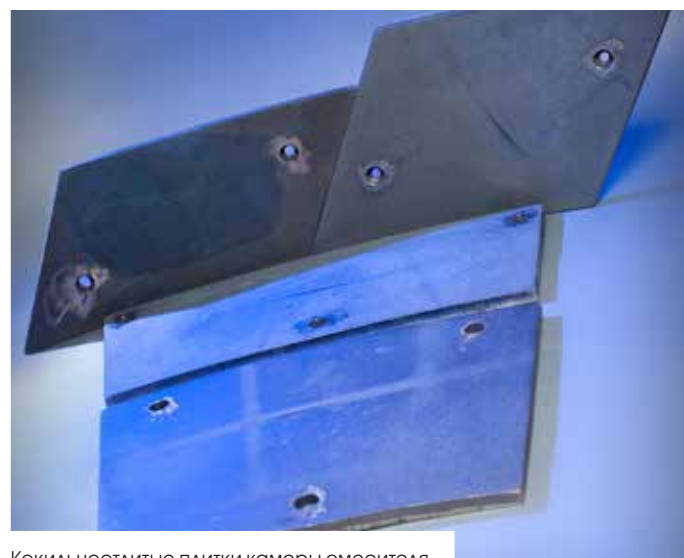
Кокильноотлитые плитки камеры смесителя
