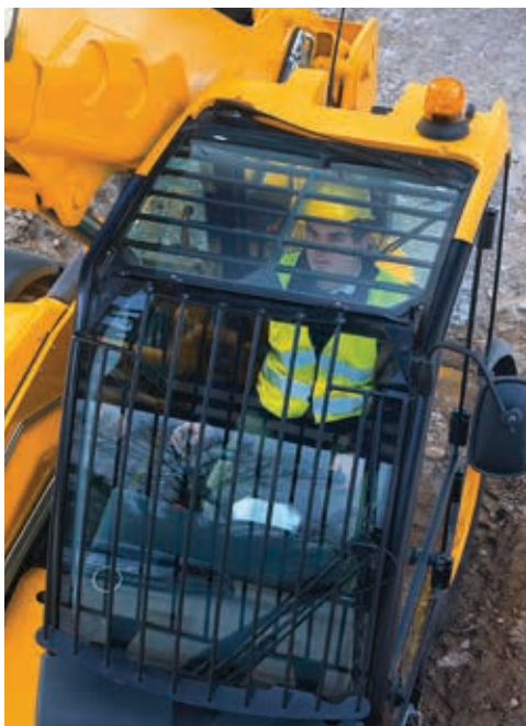
Для дополнительной защиты от падающих объектов на крыше спереди и сверху устанавливаются защитные экраны.
