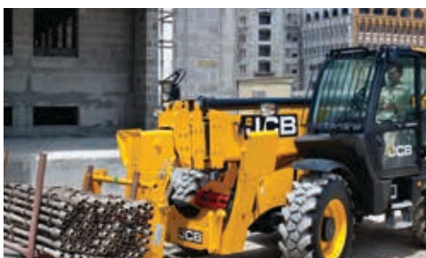
Быстръемная каретка JCB позволяет быстро и легко заменять навесное оборудование.
