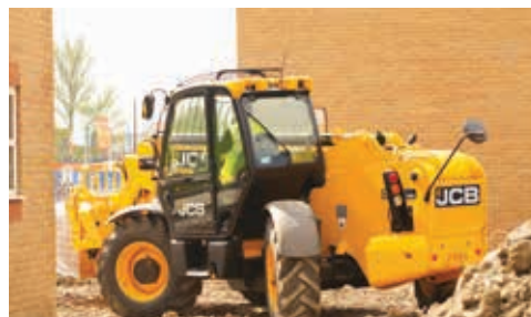
4 управляемых колеса обеспечивают превосходную маневренность
