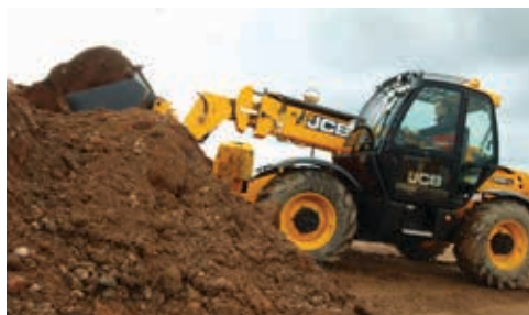
Усиленные опоры мостов поглощают нагрузки, создаваемые при боковом перемещении грузов.
