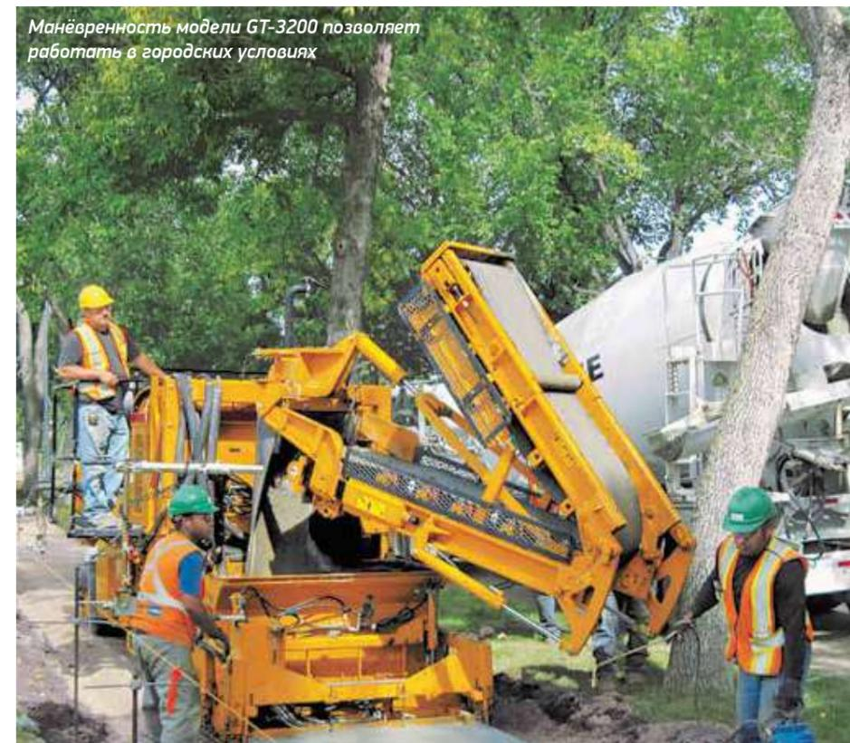
*Дополнительный конвейер длиной 4,1 м может использоваться вместо загрузочного шнека*
