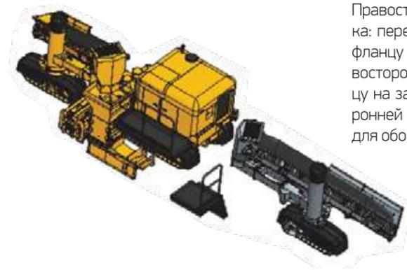
Правосторонняя или левосторонняя укладка: передняя гусеничная опора крепится к фланцу на передней части машины для левосторонней укладки или крепится к фланцу на задней части машины для правосторонней укладки. Конвейер может работать для обоих направлений укладки.
