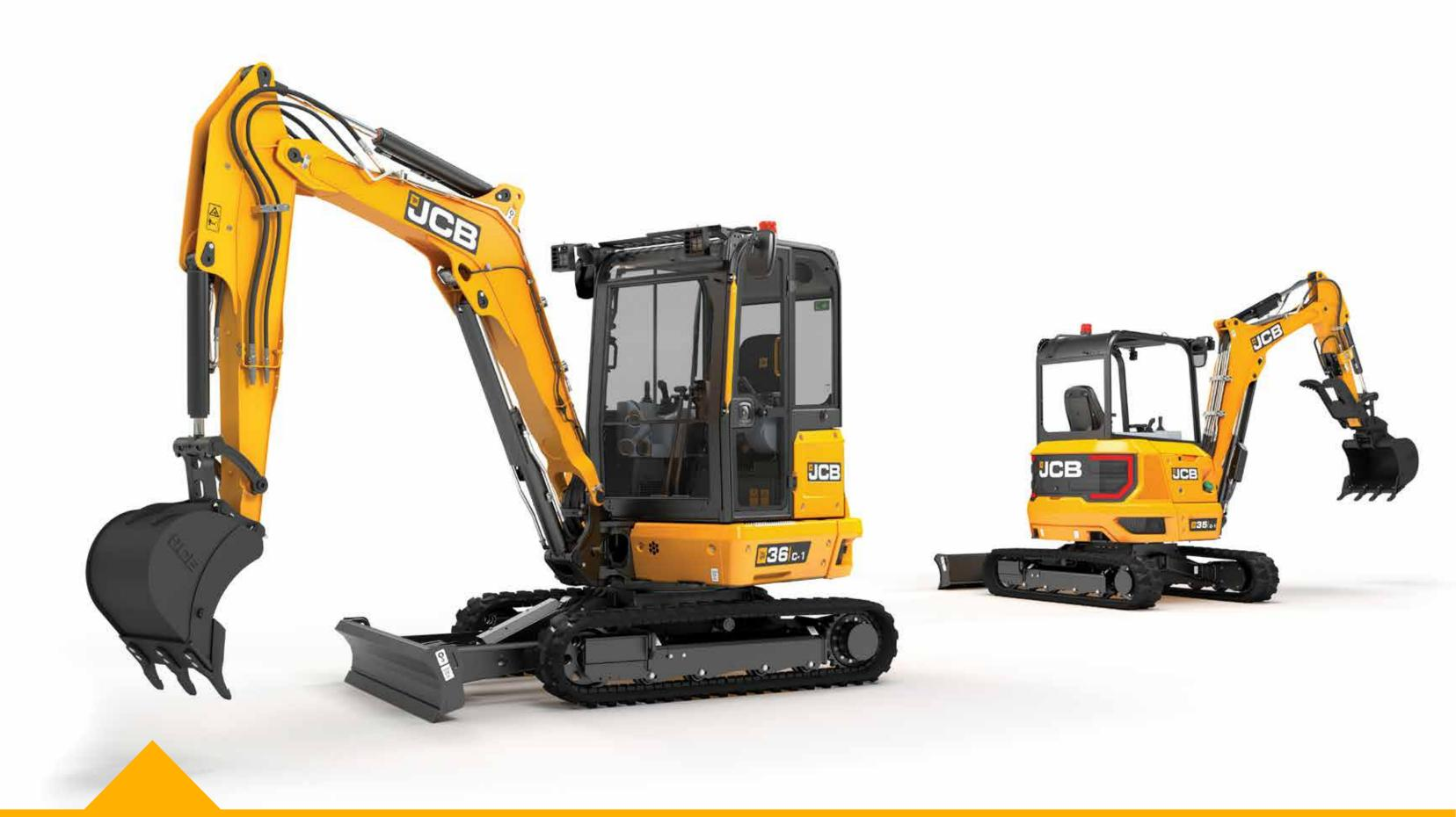
Новые экскаваторы с двигателями стандарта Stage V: 35Z-1 с нулевым вылетом противовеса и 36C-1 со стандартным вылетом противовеса.
