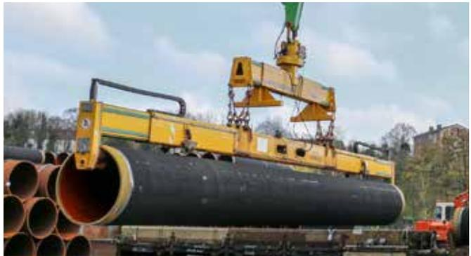
Устройство быстрой замены рабочего оборудования с траверсой
