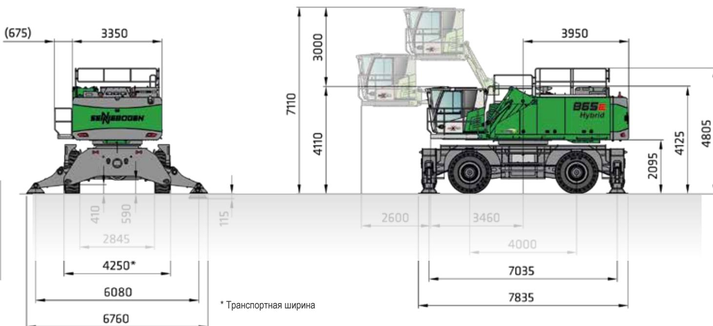
865 E HYBRID С КОЛЕСНОЙ ХОДОВОЙ ЧАСТЬЮ МР80, ГИДРАВЛИЧЕСКИМ МЕХАНИЗМОМ ПОДЪЕМА И ВЫДВИЖЕНИЯ ВПЕРЕД КАБИНЫ Е300/260 МАХСАВ INDUSTRY, СПЛОШНЫМИ РЕЗИНОВЫМИ ШИНАМИ 26.5-25 (4-СЛОЙНЫЕ)
