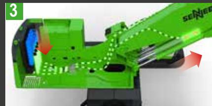
3 Накопленная энергия практически без потерь по всему ходу цилиндра идет на выполнение следующего рабочего движения — подъем стрелы
