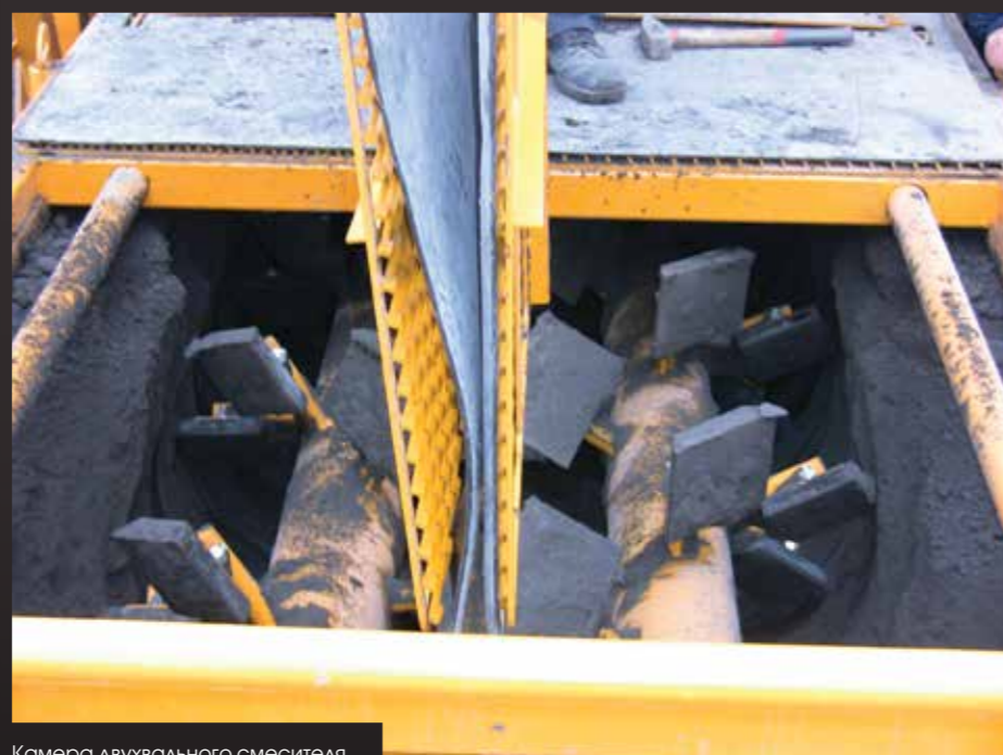
Камера двухвального смесителя
