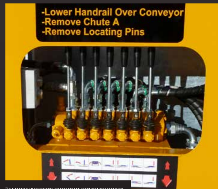
Гидравлическая система самомонтажа
