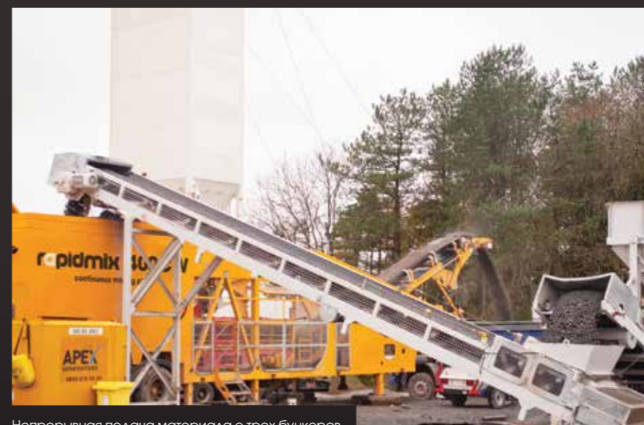
Непрерывная подача материала с трех бункеров
