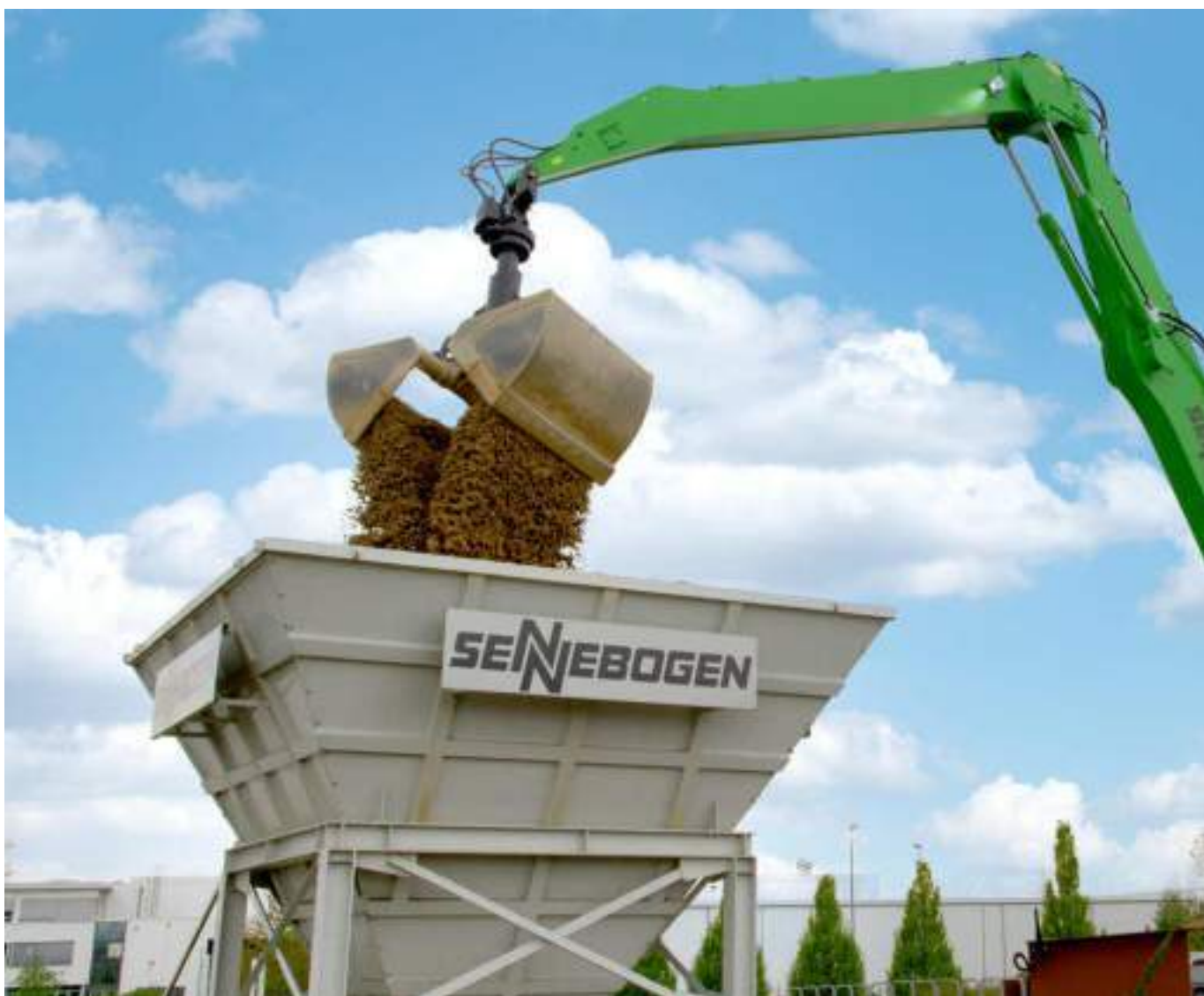
Перевалка сыпучего груза (корм, уголь и т. п.) с помощью двухчелюстного грейфера (SGZ)
