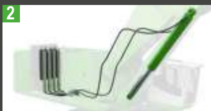
2 Модуль накопления энергии состоит из гидроцилиндра и наполненного азотом поршневого пневмогидроаккумулятора
