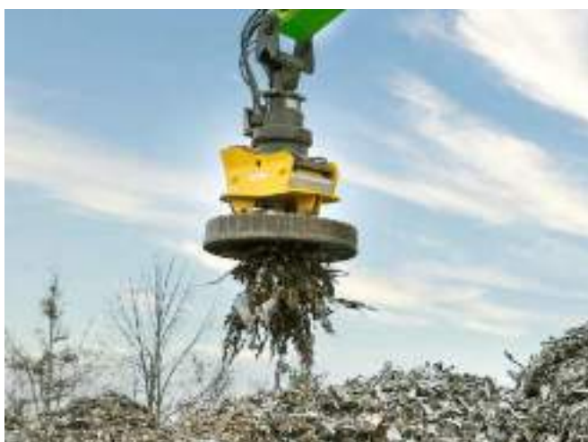
Магнит с устройством быстрой замены рабочего оборудования
