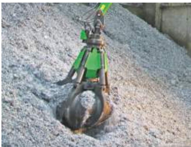
Многочелюстной грейфер (SGM), закрытые челюсти, например, для перевалки металлической стружки
