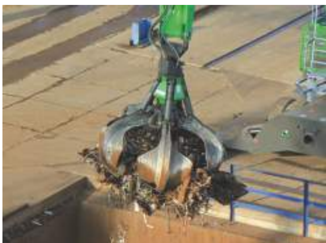
Многочелюстной грейфер (SGM), закрытые челюсти, например, для перевалки смешанного лома
