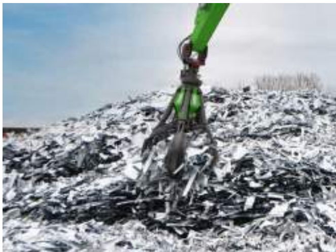
Многочелюстной грейфер (SGM), полуоткрытые челюсти, например, для перевалки обрезков листового металла
